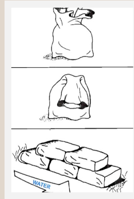
Fig. 4 LLENADO Y COLOCACION DE SACOS DE ARENA
